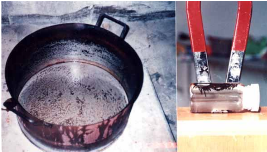
内部の錆が除去された水槽
