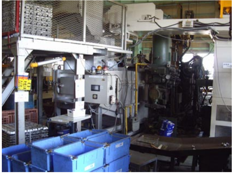
アルミダイカストマシン×5 基のジェットクーラーパイプ内 を冷却水が循環している。
